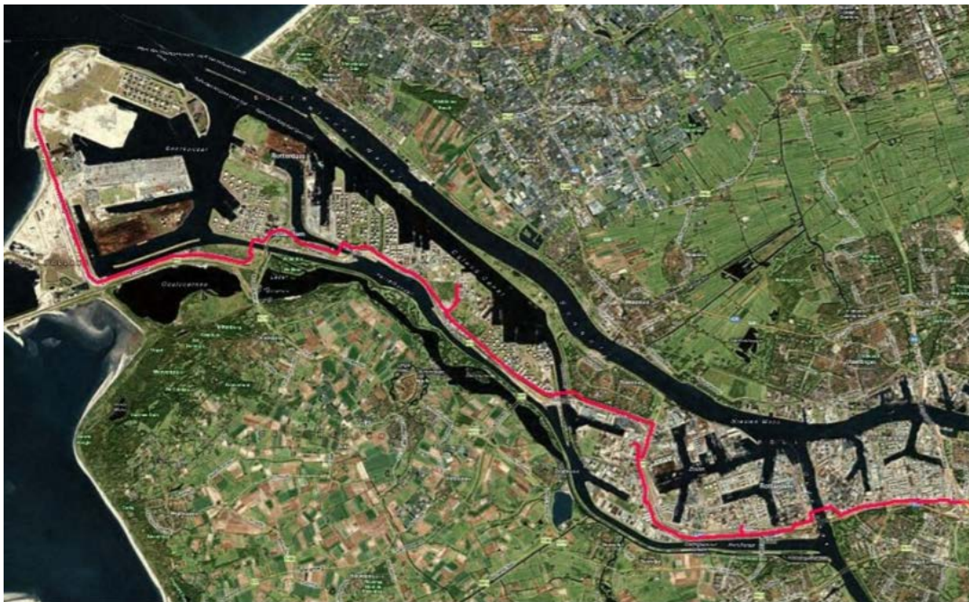
Figuur 8: Locatie waterstofleiding Air Liquide (rode lijn) in de Rotterdamse haven (Tebodin Netherlands B.V., 2015)
