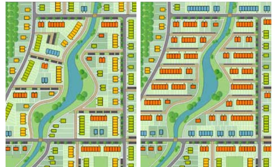
Figuur 14. Verkavelingen vergeleken. De zuidverkavelingen zijn niet alleen gunstig voor het beperken van de kosten om aan de energieprestatie-eis te voldoen, maar ze leveren ook een hogere verkoopwaarde op. Bron: IMOSS bureau voor stedenbouw bv.
